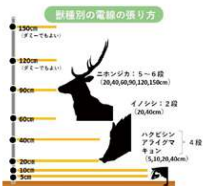
図 獣種別の電線の張り方 出典:現場指導者のための獣害対策マニュアル
